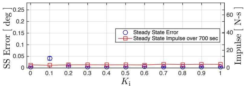
(d)  $K_i$  sweep using the REM pulse rounding method.
