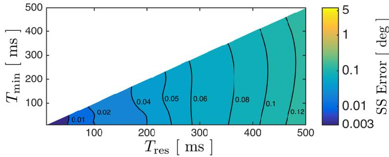
(d) Static bias sweep for the REM pulse rounding method.
